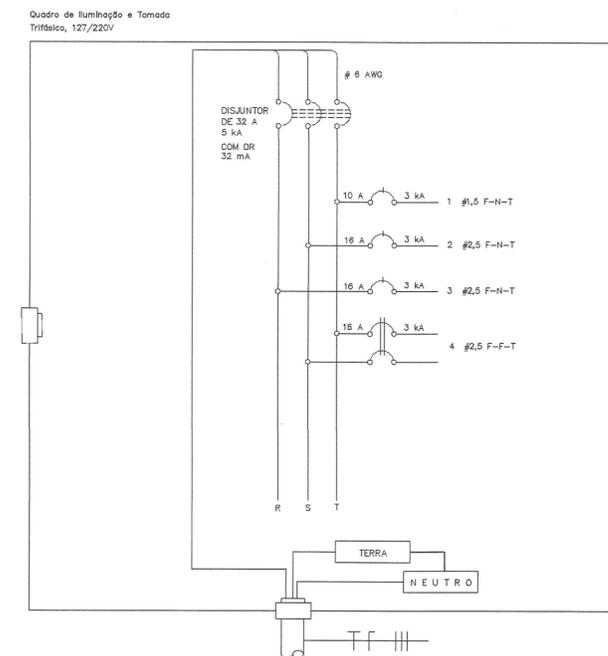
CIRCUITO 1 - ILUMINAÇÃO - CONDUTOR 1,5 mm<sup>2</sup> F-N-T - DISJUNTOR 10 A MONOPOLAR
